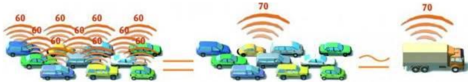
Figure 5 : addition de 10 sources sonores de même intensité (source : www.bruitparif.com )
